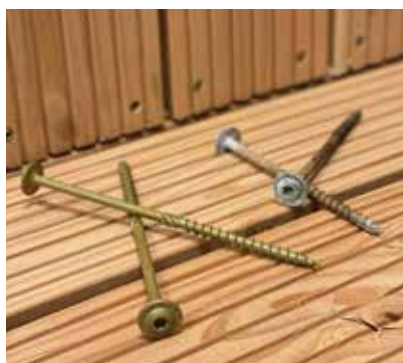
DIFFÉRENCE ENTRE LE REVÊTEMENT-AR ET LA GALVANISATION APRÈS UN SÉJOUR DE 6 MOIS DANS LE DOUGLAS
